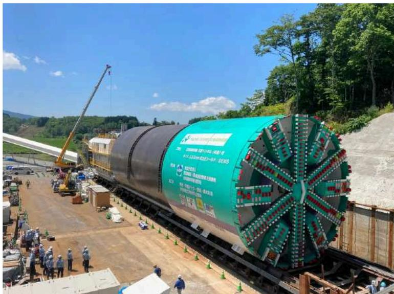
羊蹄トンネルの掘削に使われているシールドマシン（鉄道・運輸機構提供）
